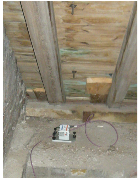
Triaxiales Geophon, montiert auf einer Aufstellplatte
